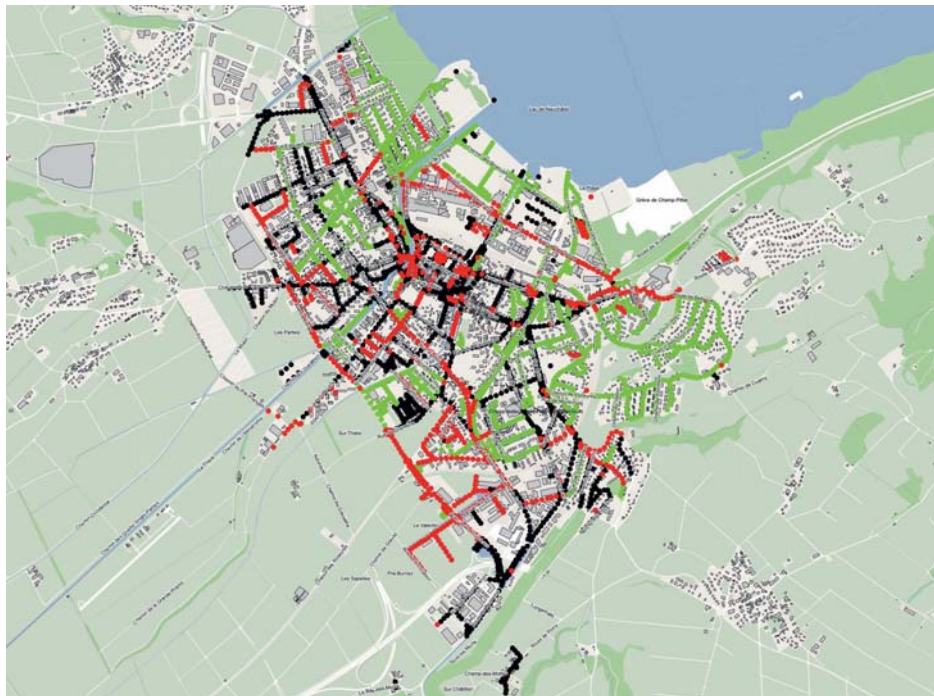
Illustration 5 : En rouge, 852 lampes LED sans détecteur, en vert, 1429 lampes LED avec détecteur, en noir 1364 lampes non LED. (Source : Ville d'Yverdon-les-Bains)
